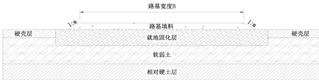
a) 低填浅挖路基软弱土浅层固化处理
