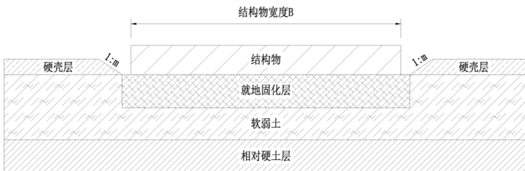
b) 结构物基础浅层固化处理
