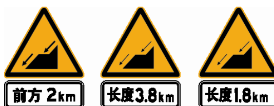
图22 长坡陡下坡标志示例
