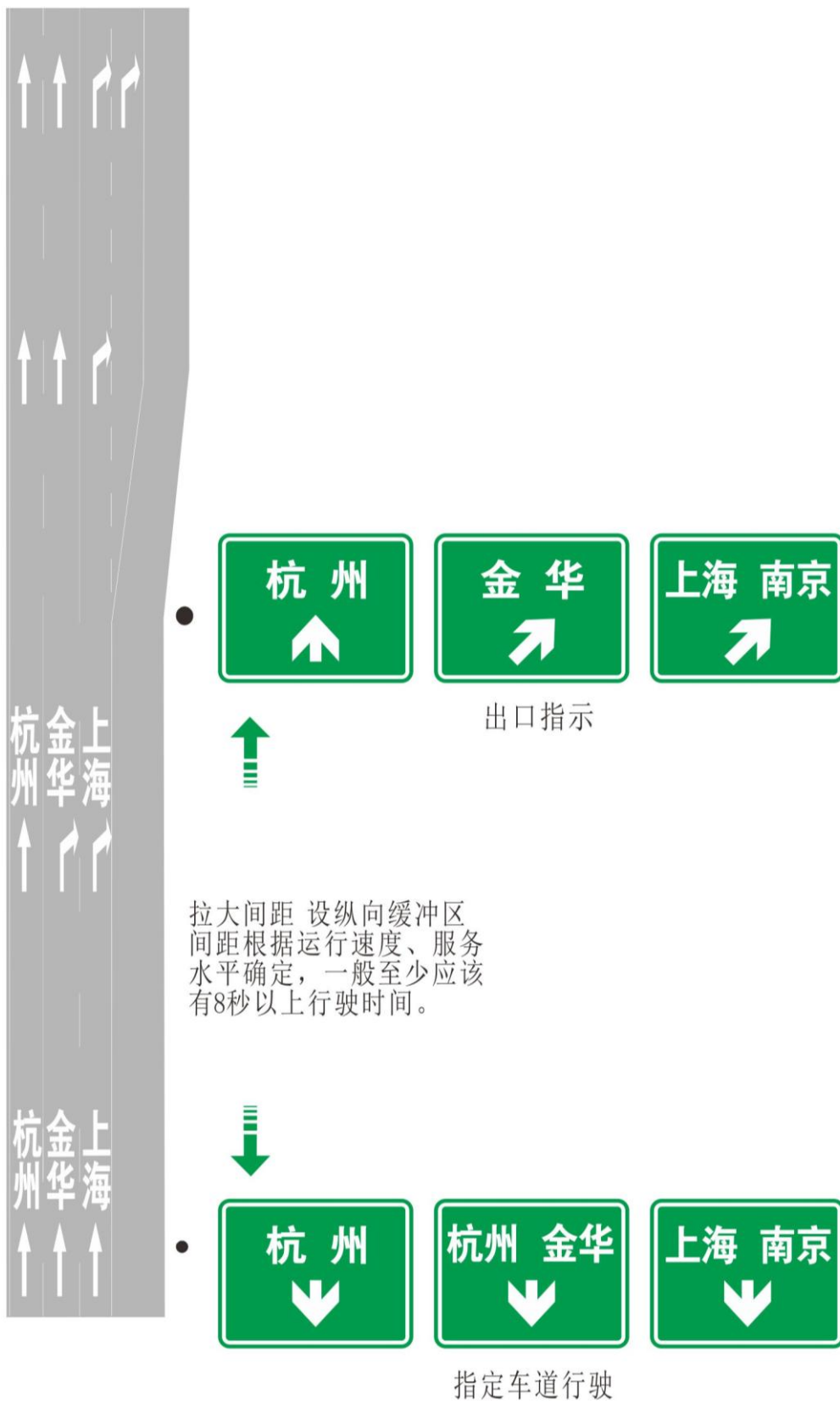
图32 纵向缓冲区设置示例
