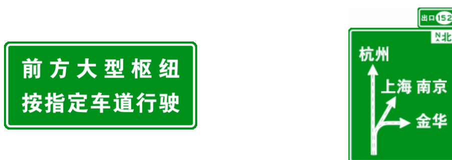
图30 大型枢纽前的交通预告标志示例（一）
